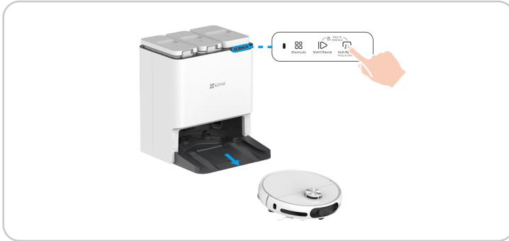
2. Nettoyez l'intérieur de la station de base et de l'évier de nettoyage avec un outil de nettoyage ou des chiffons.
