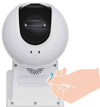
2. Lorsque la caméra est hors tension, appuyez longuement sur le bouton d'alimentation pendant 2 secondes pour la mettre sous tension.
