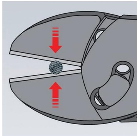
On place les fils toujours le plus proche possible de l'axe d'articulation. Lors de pinces coupantes avec une transmission élevée, l'ouverture à proximité du point de rotation est la plupart du temps plus petite que le diamètre du fil et les câbles peuvent glisser vers l'avant lors de la coupe.
