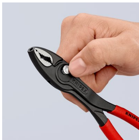
Optimisation de la géométrie de la mâchoire : mâchoire à 2 zones avec alignement opposé de la denture – pour une préhension maximale en serrant e ten desserrant.
