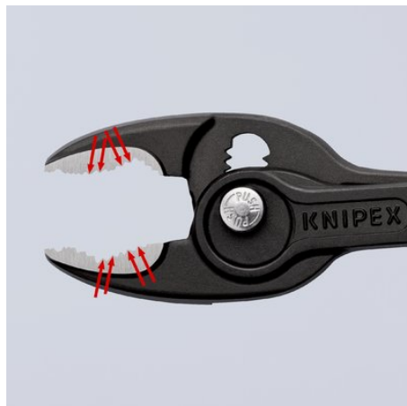
Optimisation de la géométrie de la mâchoire : mâchoire à 2 zones avec alignement opposé de la denture – pour une préhension maximale en serrant e ten desserrant.
