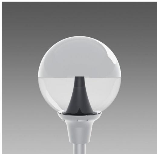
Globo : polycarbonate incassable et autoextinguible V2, stabilisé aux rayons UV, anti-jaunissement. Très grande transparence, idéale pour la transmission du flux lumineux. Partie supérieure peinte pour observer les limites posées par les normes sur la lutte contre la pollution lumineuse.
