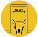
Brouette équipée d'une caisse étroite et profonde passant par toutes les portes, idéale pour les travaux de rénovation.
