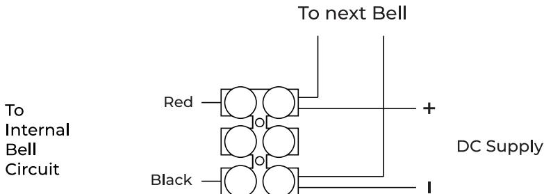
Wiring Diagram 1 (DC)
