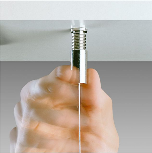
suspension avec câble en acier diam. 1,5 mm et longueur 1,75 m avec réglage millimétrique. Charge max. : 20 kg.
