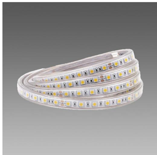
Rubans de LED à poser avec adhésif 3M sur surfaces lisses, propres et sèches. Éviter de poser sur les surfaces à angles vifs et d'abîmer les composants. Les rubans peuvent être découpés selon les traits de coupe. \*Attention : utiliser un cutter et non pas des ciseaux pour les découpes. Pour garantir le bon fonctionnement et le degré IP, rétablir l'alimentation d'origine des rubans (le cas échéant, utiliser des connecteurs). Remarque valable pour tous les rubans de LED.
