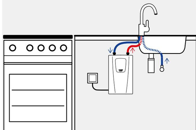
Installation alternative avec **des robinetteries résistant à la pression** sur un **lavabo double**.
