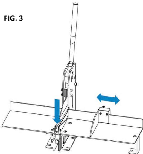
4.1. Ajuster la longueur souhaitée pour la goulotte au niveau de l'équerre d'épaulement puis fixer la position à l'aide de la vis à oreilles. Enfoncer la protection de la lame avec la goulotte vers le bas.
