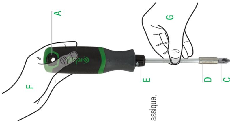
Tenir le manche d'une main (F) saisir la lame du tournevis entre les doigts de l'autre main (G) faire tourner rapidement la lame jusqu'à ce que la vis amorce son serrage. Quand vous ne pouvez plus faire tourner la lame entre les doigts, se servir du manche et du cliquet pour effectuer un serrage puissant.
