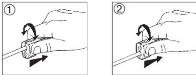
Outil simple pour dégainer et dénuder les câbles coaxiaux de Ø 4,8 à 7,5 mm.
