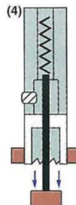
(4) En fin de cycle le foret pilote éjecte la débouchure et la machine s'arrête (Idem WA5000)
