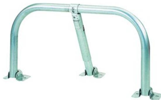
**841003**, **841002**, **841001** : très robuste en tube Ø 49 mm. Prévue pour être manipulée durement et supporter en position basse le passage de la voiture. Socles de base en tôle épaisse emboutie, enrobant le tube et n'offrent aucune aspérité dangereuse. Serrure de sûreté à barillet fixe protégé. Le verrouillage s'enclenche automatiquement en remontant l'arceau. L'ensemble est galvanisé à chaud. Mise en place facile et rapide par scellement ou par boulons (en option).
