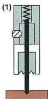
(1) Positionner le foret pilote sur l'emplacement à percer
