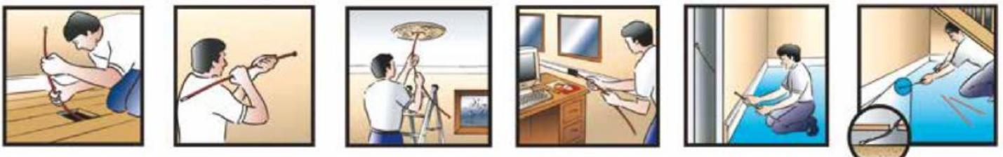
La gamme de baguettes tire-fils a été conçue afin de faciliter les travaux effectués par des électriciens et professionnels du bâtiment dans des endroits difficilement accessibles. La gamme comprend des baguettes et des accessoires.
