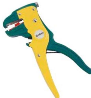
**421057** : pince auto-ajustable pour câbles monobrins et multibrins de section 0.2 à 6.0 mm<sup>2</sup>. Forme ergonomique, poignée bimatière, lames interchangeables. Dénudage rapide et impeccable de la majorité des isolants. Coupe-fils incorporé de capacité 2.5 mm<sup>2</sup> (souple). Longueur de dénudage réglable par butée de 6 à 18 mm. Approuvée TÜV/GS.
