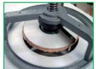
Utilisation de l'adaptateur rénovation sur Multispot, Maxi, Mega et Giga.
