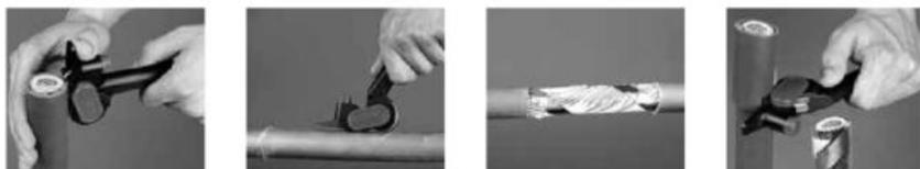
**433195** : dénude-câbles universel pour câbles de diamètre supérieur à 25 mm. Le système d'avance à cliquet permet de dégainer sans effort les isolants synthétiques les plus durs. Profondeur de coupe réglable jusqu'à 5 mm, lame interchangeable à deux taillants.
