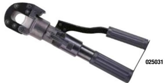
**025041** : coupe les câbles cuivre et aluminium. Pompe manuelle incorporée, la tête pivote sur 180° pour faciliter la position de travail. Charge maximum admissible de la pompe, 20 kgf, force 50 kN.
