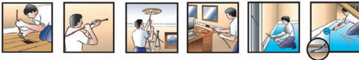
La gamme de baguettes tire-fils a été conçue afin de faciliter les travaux effectués par des électriciens et professionnels du bâtiment dans des endroits difficilement accessibles. La gamme comprend des baguettes et des accessoires.
