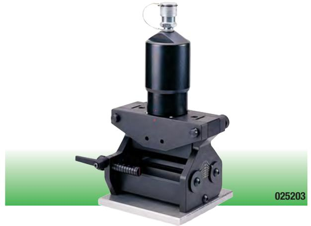
**025208** : cintre les barres cuivre jusqu'à 160 mm de large. Lecture du degré de cintrage. Nécessite une pompe hydraulique manuelle ou électrique 700 bars maxi. Force 250 kN.
