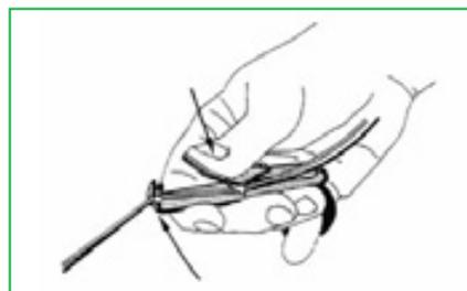
Mise en place de l'outil sur les fils. Serrer légèrement le couteau jusqu'au pincement des fils. S'assurer que les fils sont bien engagés au fond de l'encoche de dénudage.
