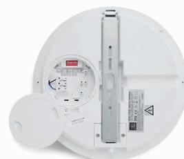
Hublot en polycarbonate renforcé. Il est équipé d'un switch, permettant de choisir la température de couleur à l'installation : 2700, 3000 ou 4000K. Son système de fixation simplifié (étrier de fixation), vous fera gagner du temps à l'installation. La version avec détecteur HF dispose d'une portée de 6 m. Le détecteur peut être désactivé. Le luminaire est équipé d'un driver flicker free pour améliorer le confort des utilisateurs.
