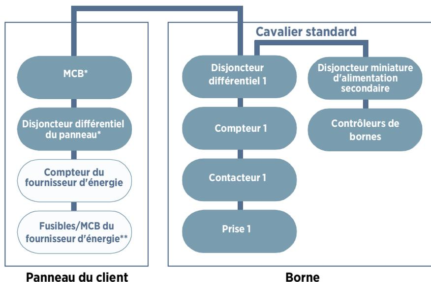
\* Disjoncteur différentiel de panneau en option. Installez un tel dispositif conformément à tous les codes et réglementations applicables, selon les besoins.
