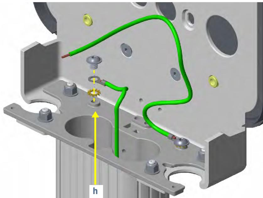
9. **Installateurs du Royaume-Uni uniquement** : utilisez le câble de mise à la terre, les vis à tête ronde M8 et les rondelles dentées fournis dans le carton du kit de mise à la terre pour connecter le presse-étoupe à n'importe quel trou disponible du support de tête.
