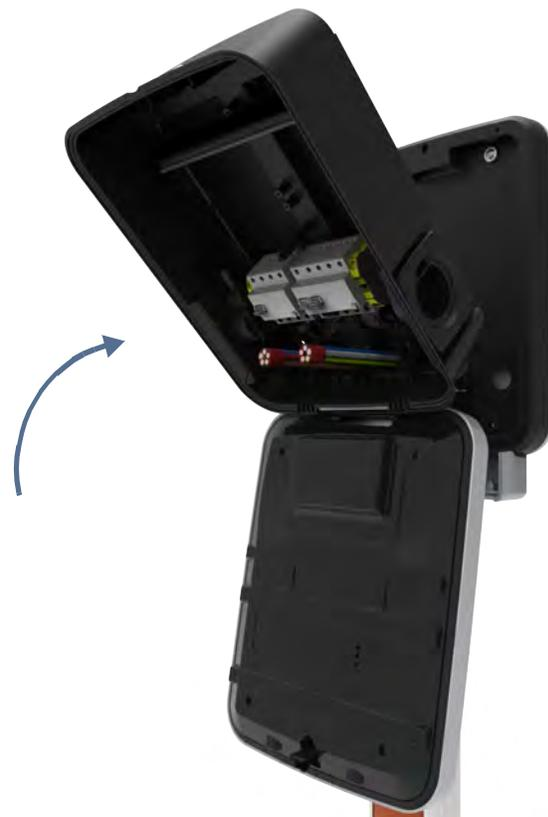
10. À l'aide d'un tournevis Torx T25 et de quatre vis 25 mm M6, fixez la borne de recharge. Serrez les vis à un couple de 6,5 Nm.
