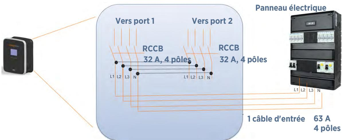
\*\*RCCB : disjoncteur différentiel avec protection contre les surintensités
