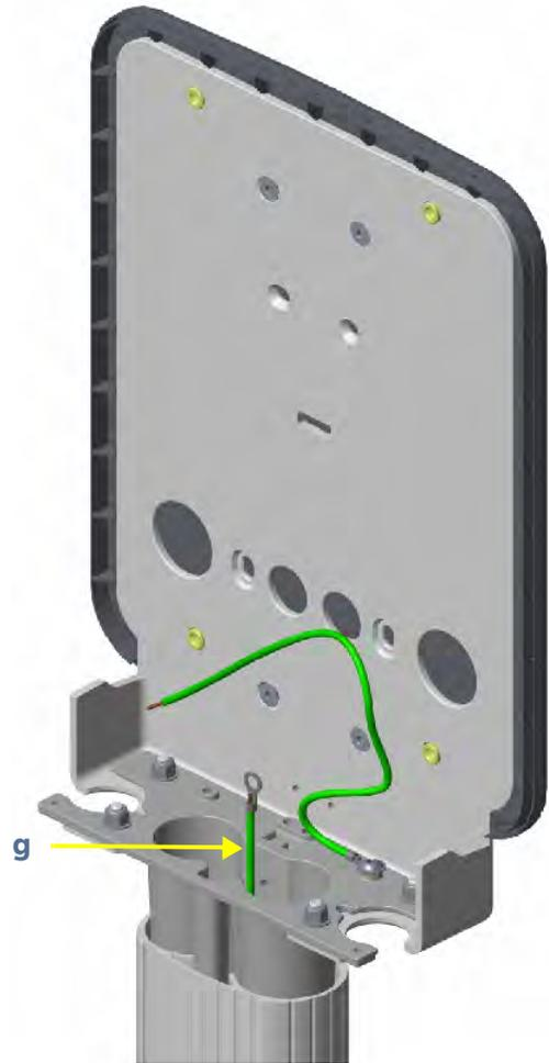
6. Abaissez le support de fixation de la borne assemblé sur le pied, en plaçant délicatement le support de tête sur la colonne.
