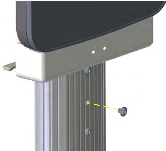
8. À l'aide d'un tournevis doté d'un embout hexagonal 5 mm, d'une vis à tête ronde 10 mm M8 et d'une rondelle dentée, connectez le câble de mise à la terre préinstallé situé dans la colonne pour fixation sur pied au support de tête (h). Serrez la vis à un couple de 16 Nm.
