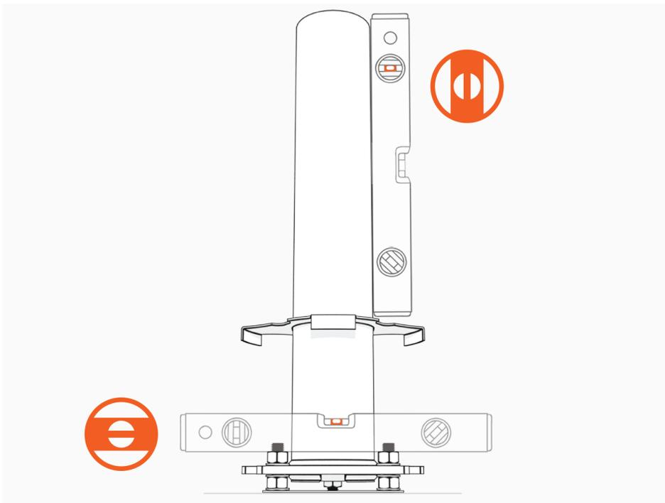
9. Serrez les écrous supérieurs à **120 Nm**.
