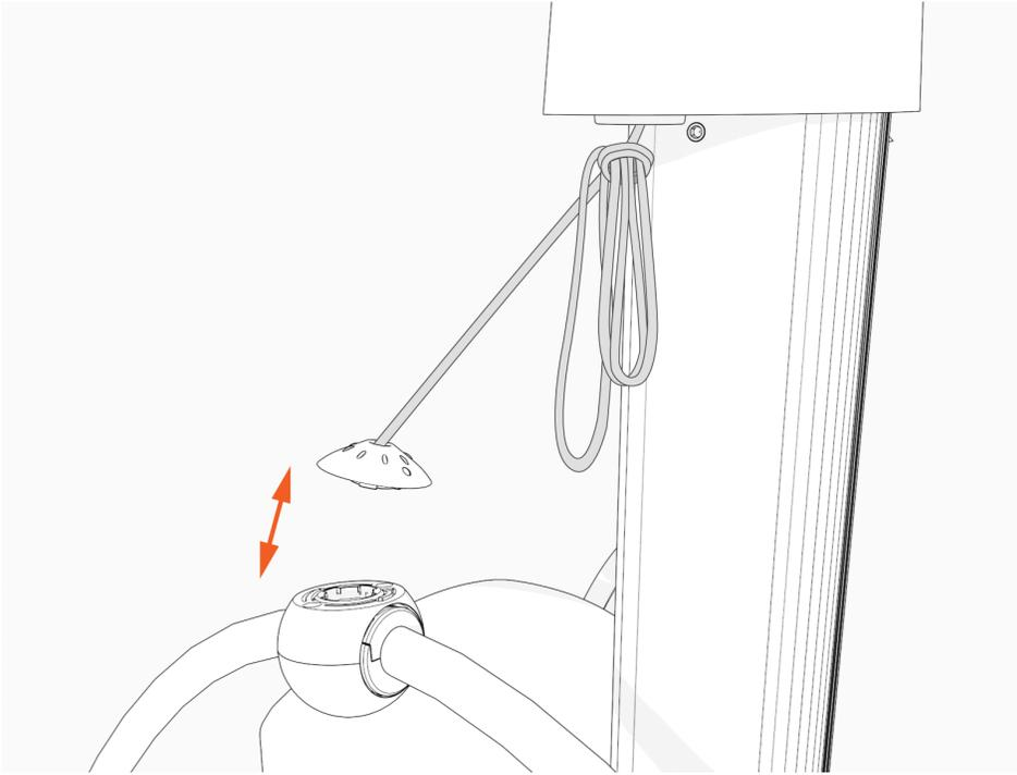
4. À l'aide de l'outil fourni, poussez vers le bas tout en tournant l'attache sphérique dans le sens des aiguilles d'une montre d'environ 1/4 de tour pour connecter le serre-câble.
