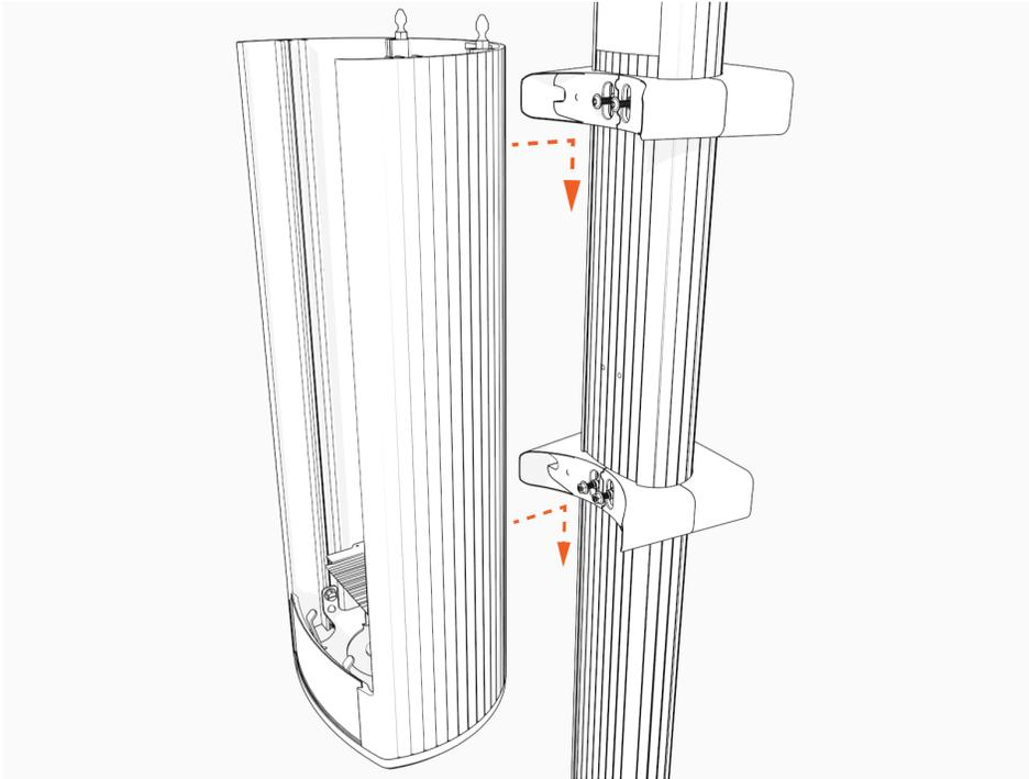
4. Utilisez la clé en L ou la mini clé à cliquet pour serrer les deux vis à bride (en haut) et les deux écrous préinstallés (en bas) à un couple de **5,7 Nm**.
