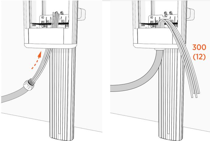
2. Sélectionnez le presse-étoupe ou le matériel et le scellant appropriés, le cas échéant, pour fixer le conduit à la borne.
