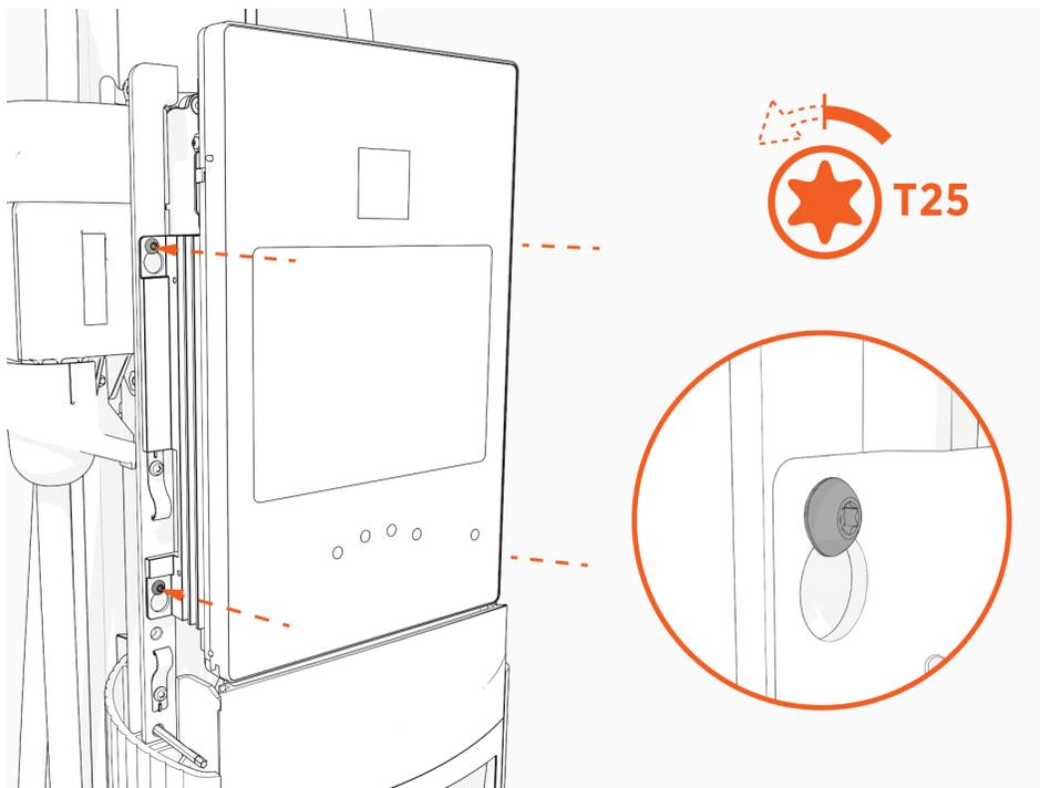
14. Soulevez le CCOM et éloignez-le de la partie supérieure en l'inclinant. Le bord inférieur du CCOM repose sur le bord supérieur de l'ensemble support.
