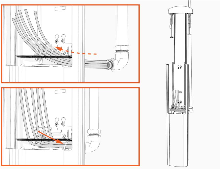
3. Scellez l'entrée du conduit dans le boîtier du pied à l'aide d'une méthode de scellement approuvée et conforme aux codes en vigueur.
