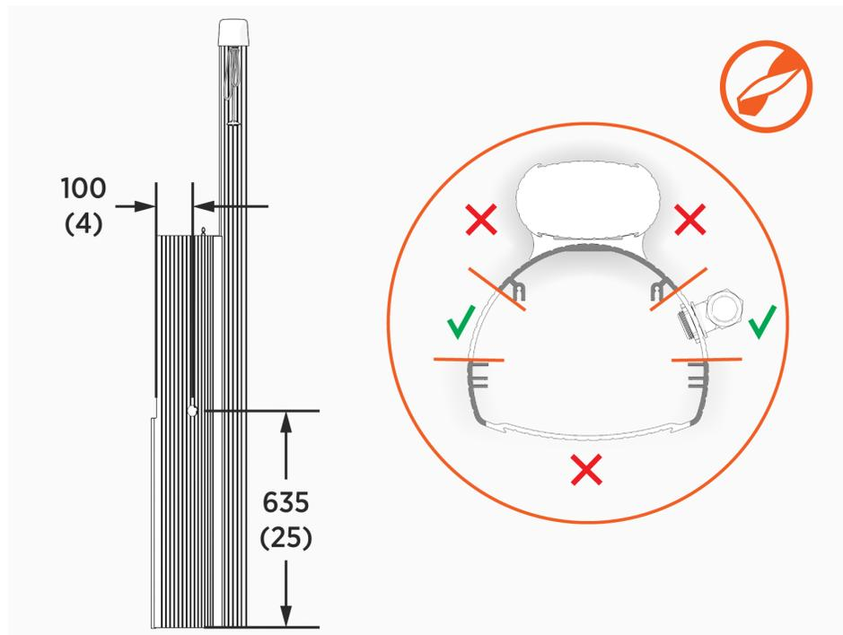
2. Passez les câbles dans le conduit, en les protégeant des bords tranchants des composants structurels internes.
