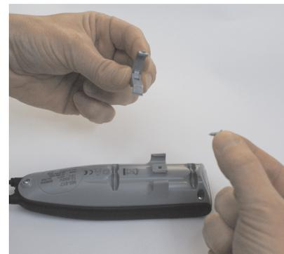
2. Visser la vis fournie à l'aide d'un tournevis cruciforme jusqu'à ce que l'accroche tableau soit plaqué sur le corps du VAT (ne pas continuer à visser après).
