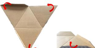
B - Falten Sie die 3 mit doppelten Klebestreifen abgedeckten Kanten nach innen.
