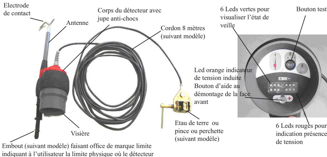
Embout (suivant modèle) faisant office de marque limite indiquant à l'utilisateur la limite physique où le détecteur peut toucher des pièces sous tension
