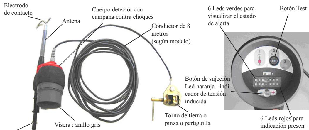
Embudo (según modelo) - indica también la marca límite : hasta donde el usuario puede introducir el detector entre los conductores o partes en tensión.
