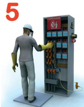
**5** Mettre à la terre et en court-circuit (nécessaire si : risque de remise sous tension des installations, condensateurs, longs câbles.)
