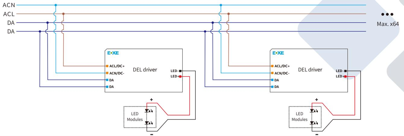
**PUSH DIM : Schéma de cablage / Wiring diagram**
