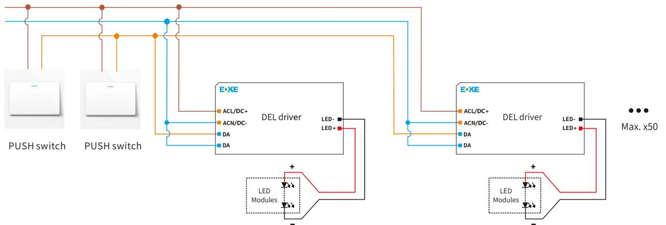
**1-10V / 10V PWM : Schéma de cablage / Wiring diagram**
