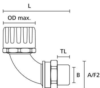
Raccord HelaGuard, coudé à 90° avec filetage externe tournant
