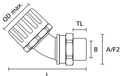
Raccord HelaGuard, coudé à 45° avec filetage externe tournant
