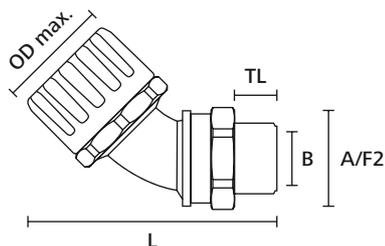
Raccord HelaGuard, coudé à 45° avec filetage interne tournant
