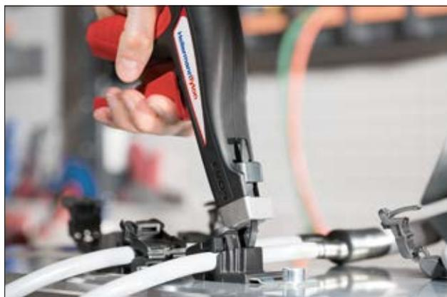
La bande de serrage peut être utilisée pour assurer un serrage constant de la bride.
