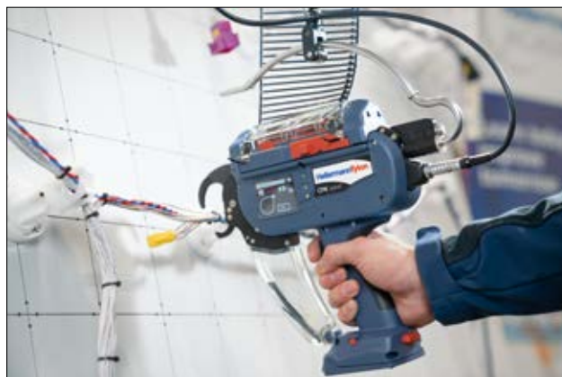
Autotool CPK hybrid avec alimentation et potence.
