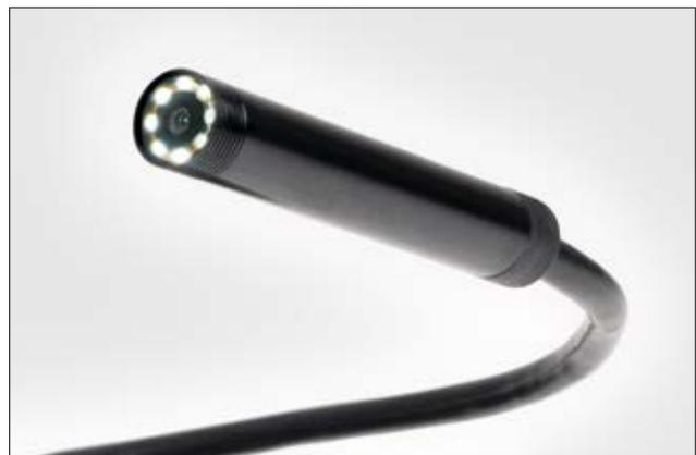
Lentille de la caméra de 8 mm avec 8 mini lampes LED.
