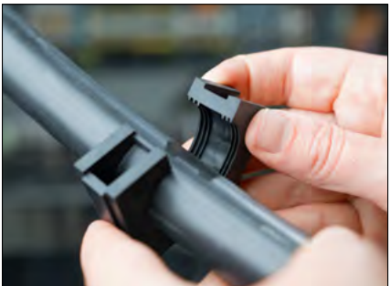
Les nervures flexibles dans les trous des inserts compensent jusqu'à 0,4 mm de tolérance le diamètre du câble
