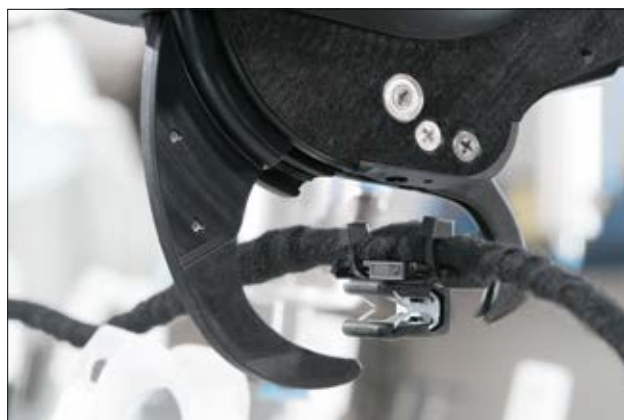
EdgeClip pour outil de pose automatique (AT2000CPK / ATS3080)
