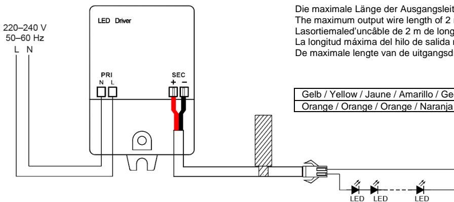
Die maximale Länge der Ausgangsleitung von 2 m darf nicht überschritten werden.
