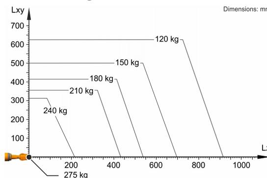
KR 210 R2700-2 est conçu pour une charge nominale de 210 kg pour une utilisation optimale de la performance et de la dynamique du robot. Seulement si la position du centre de gravité = 0 mm et une charge supplémentaire optimisée pour le cas de charge sont attachées, la charge maximale de 275 kg s'applique. Les cas de charge spécifiques doivent être contrôlés avec KUKA Load ou KUKA Compose. Notre assistance technique KUKA Support est à votre disposition pour vous conseiller.
