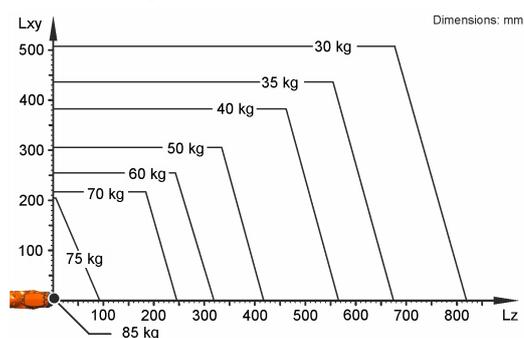
KR 70 R2100 est conçu pour une charge nominale de 70 kg pour une utilisation optimale de la performance et de la dynamique du robot. Avec des distances de charge réduites et des charges supplémentaires avantageuses, il est possible d'appliquer une charge maximale allant jusqu'à 85 kg. Les cas de charge spécifiques doivent être contrôlés avec KUKA Load. Le SAV KUKA est à votre disposition pour vous conseiller.
