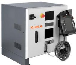
Le système de commande de robot KUKA KR C5 permet une solution de commande sur mesure pour diverses applications avec des robots industriels et des cinématiques supplémentaires.
