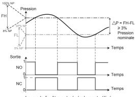
Le mode fenêtre est généralement utilisé pour les applications de "régulation de pression".
