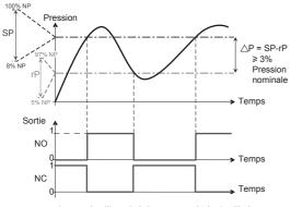
Le mode d'hystérésis est en général utilisé pour les "applications de pompage et/ou de vidage".
