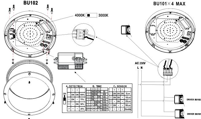
A. Possibilité de régler le diamètre de détection, 100% = 10m, 75% = 7,5m, 50% = 5m, 25% = 2,5m.
