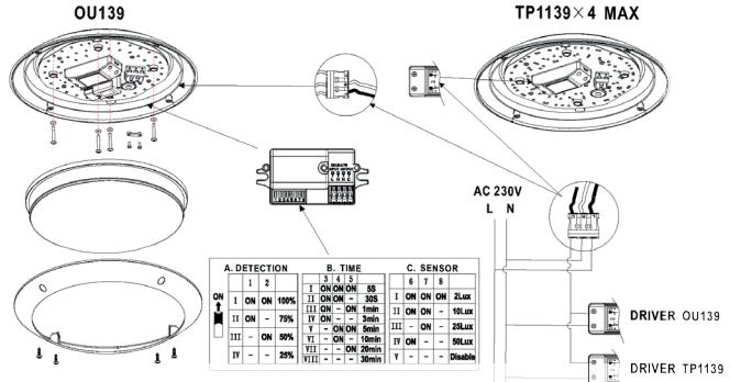
A. Possibilité de régler le diamètre de détection, 100% = 10m, 75% = 7,5m, 50% = 5m, 25% = 2,5m.
