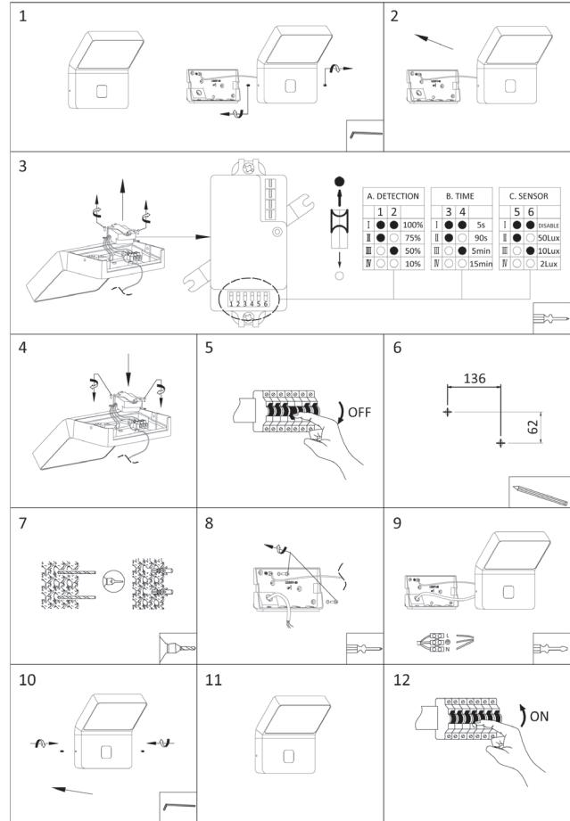
A. Possibilité de régler la distance de détection, 100% = 8M, 75% = 6M, 50% = 4M, 10% = 0,8M
