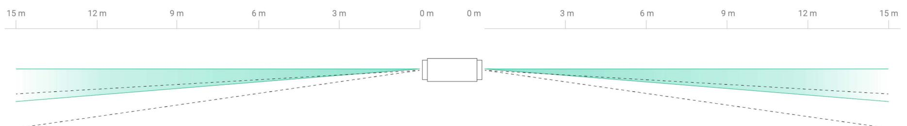
L'angle de direction du faisceau peut être incliné à 3° pour éviter les parties saillantes du bâtiment
