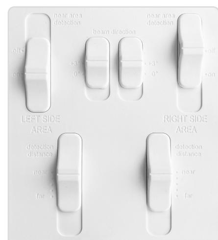
Chaque côté du DualCurtain Outdoor dispose d'une zone de détection réglable en distance et en direction. Ils permettent d'ajuster le détecteur en fonction de l'architecture et d'assurer une détection précise de la menace.
