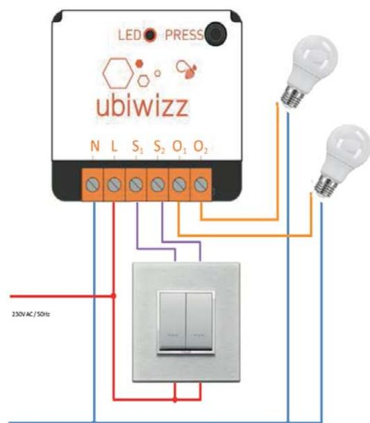
Câblage avec un interrupteur filaire
