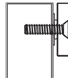
Percer un trou de 6,8 mm du côté contreplaque. Tarauder à M8 x 1,25.
