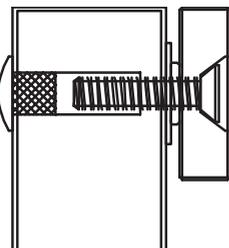
Percer un trou de 8 mm au travers de la porte. Agrandir à 12 mm sur 35 mm de profondeur du côté insert fileté.
