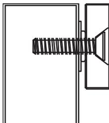
Percer un trou de 6,8 mm du côté contreplaque. Tarauder à M8 x 1,25.
