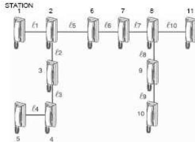
Note : La résistance de boucle ne doit pas dépasser 200 ohms pour la ligne de communication entre l'interphone le plus éloigné (postes ⑤ et ⑩) du système
