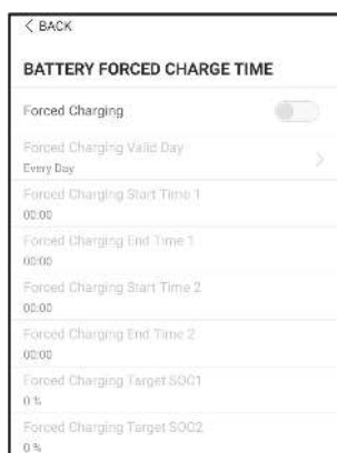
figure 8-21 Temps de charge forcée de la batterie
