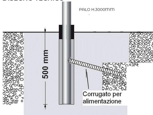
Plinto cemento dim. 1000 x 1000 x 600 mm H
