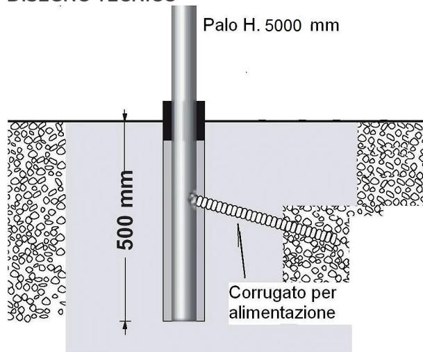
Plinto cemento dim. 1000 x 1000 x 600 mm H
